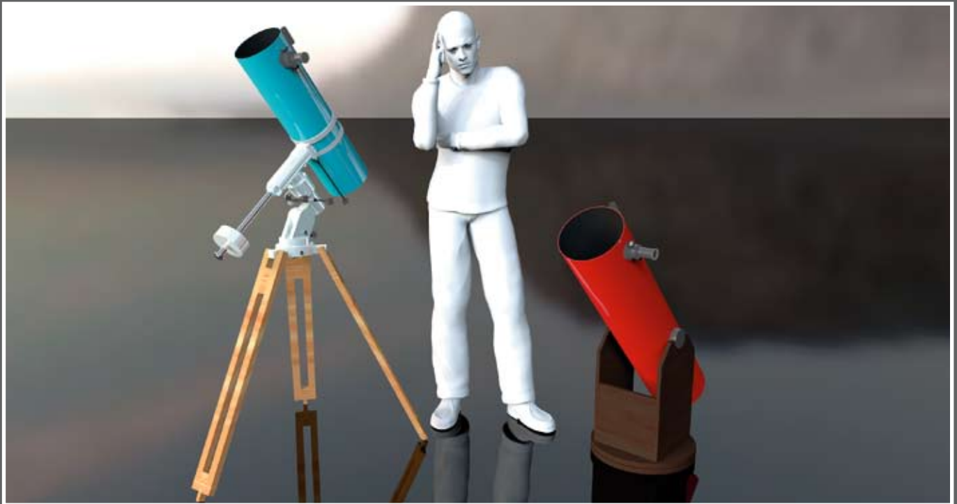
Größenvergleich zwischen einem 15cm f/5 Newton, parallaktisch montiert und einem 20cm f/6 Dobson
